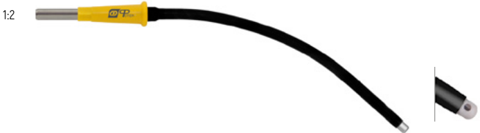
Электрод для аргонусиленной коагуляции, изогнутый, длина 160 мм, боковой факел Argon coagulation electrode, angled, length 160 mm, lateral beam
